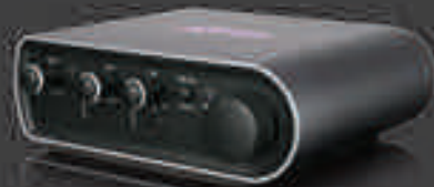
Pro Tools Mbox Mini | Sistema de grabación 2 x 2 de 24-bits / 48 kHz USB 1.1
