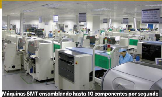
Máquinas SMT ensamblando hasta 10 componentes por segundo
