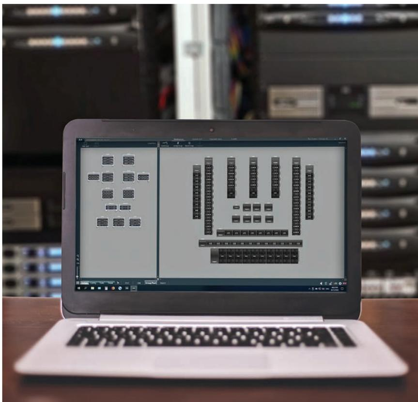
natural donde los ingenieros de sistema pueden planear y trabajar. El espacio de trabajo está dividido en dos partes, donde los amplificadores ocupan el lado izquierdo y los altavoces el lado derecho. Los usuarios pueden deslizarse a través de cuatro pasos principales: Diseño, Configuración, Ajuste y Mostrar, cada uno ofreciendo una variedad de funciones. Una vez que la función Link es completada, las operaciones pueden ser realizadas directamente desde el altavoz. Probar diferentes pre-
